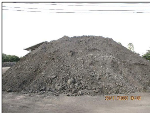
ภาพที่ 2.27 ตะกอนจากระบบบำบัดน้ำเสียทางชีวภาพ ที่นำไปทำปุ๋ยหมักชีวภาพ
