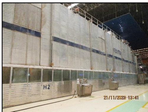
ภาพที่ 2.59 ห้องครอบเสียงเครื่องจักรภายในโครงการ
